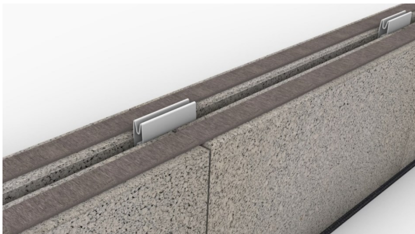
Bild 7.2 Närbild av Styrningsdetalj Innervägg.
