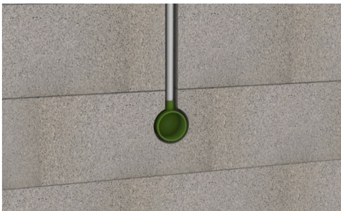
Bild 13.1 Spårning för elrör eller flexslang utförs i bärande innervägg i vertikalled.
