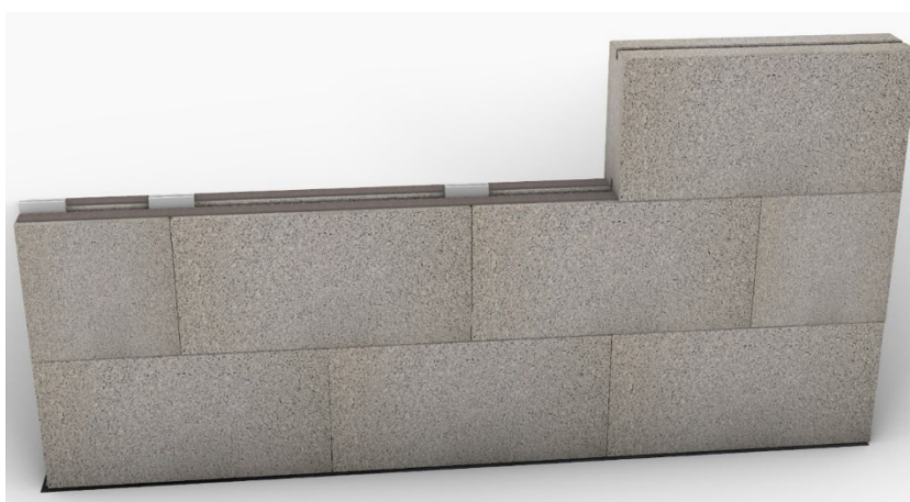
Bild 7.3 Blocken ska monteras med minst 100 mm överlapp.
