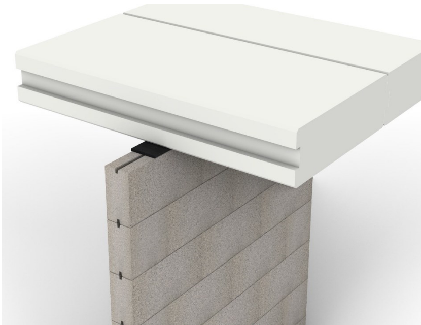
Bild 11.1 Upplag av prefabricerat bjälklag på bärande innervägg.
